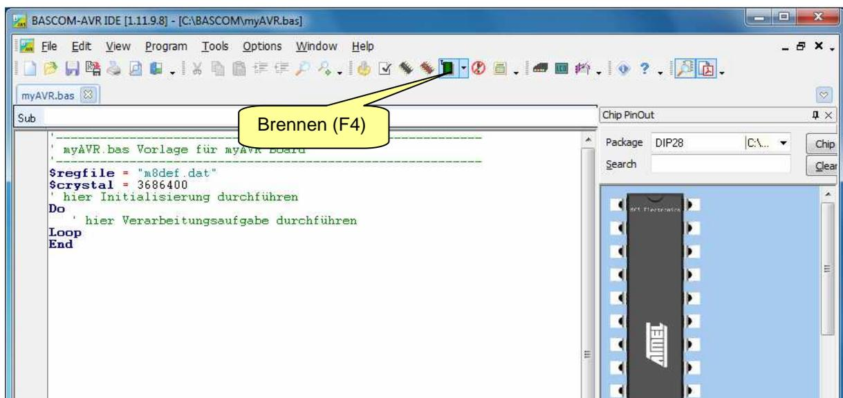
Beim Brennen öffnet sich kurz das Programmierfenster und verschwindet nach erfolgreichem Brennen wieder. Treten beim Brennen Fehler auf, so sind diese in dem Programmierfenster aufgelistet und erkennbar an dem Symbol
