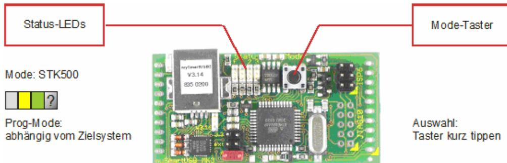
Die folgende Abbildung zeigt die korrekte Einstellung für den mySmartUSB MK3
