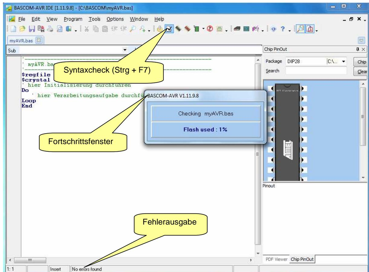
Nach Prüfung der Syntax kann das Programm kompiliert werden
