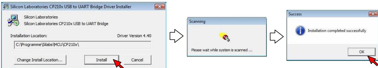
Dieses Programm bereitet den eigentlichen Installationsvorgang beim Erkennen des USB Gerätes vor. Ist der Vorgang erfolgreich verlaufen, kann der USB Programmer angeschlossen werden.
