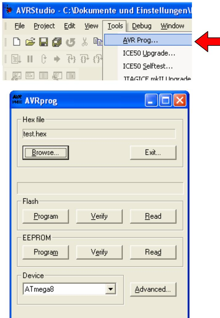
„AVR-Prog“ sucht standardmäßig nur an den COM-Ports 1 bis 4. Sollte der virtuelle COM-Port des mySmartUSB MK2 höher liegen findet das AVR Studio den Programmer nicht. In dem Fall muss über die Systemsteuerung ein für das AVR-Studio gültiger COM-Port zugewiesen werden. Dazu benötigen Sie Administratorrechte.
